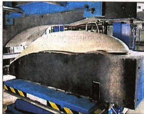
Rührflügel für die Wasseraufbereitung, aus Kunststoff gegossen. F.: Schwartz
