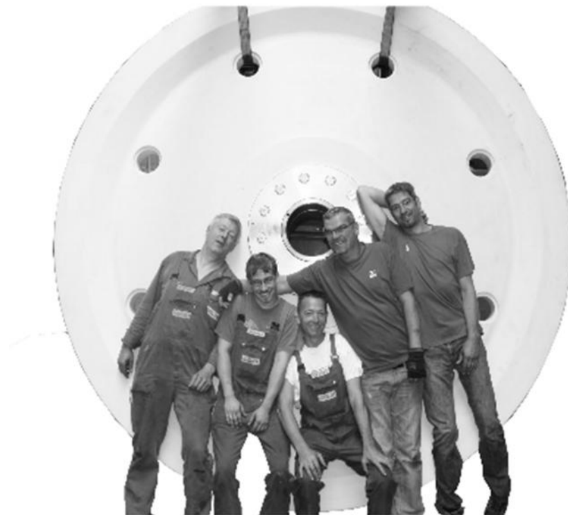
Bild 1: Seilrolle aus PA 6 mit einem Außendurchmesser von 3080 mm
